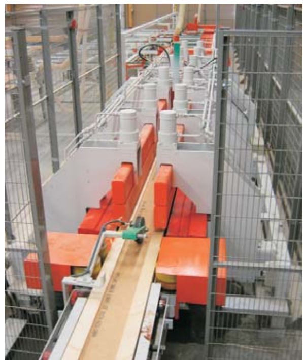
Hydraulipuristimessa PRT-Lami I-palkin uumalevy ja puupaartteet liimataan säänkestävällä liimalla mittatarkasti toisiinsa.
